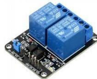
Fig-6: Relay Module
